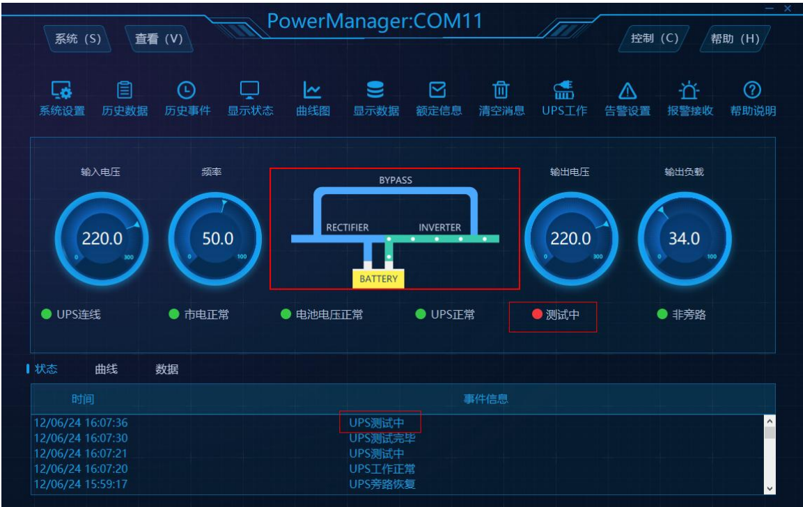
7：旁路告警如下图：流水线从 BYPASS 线路走，旁路指示灯显示红色，告警栏出现 UPS 旁路信息；
