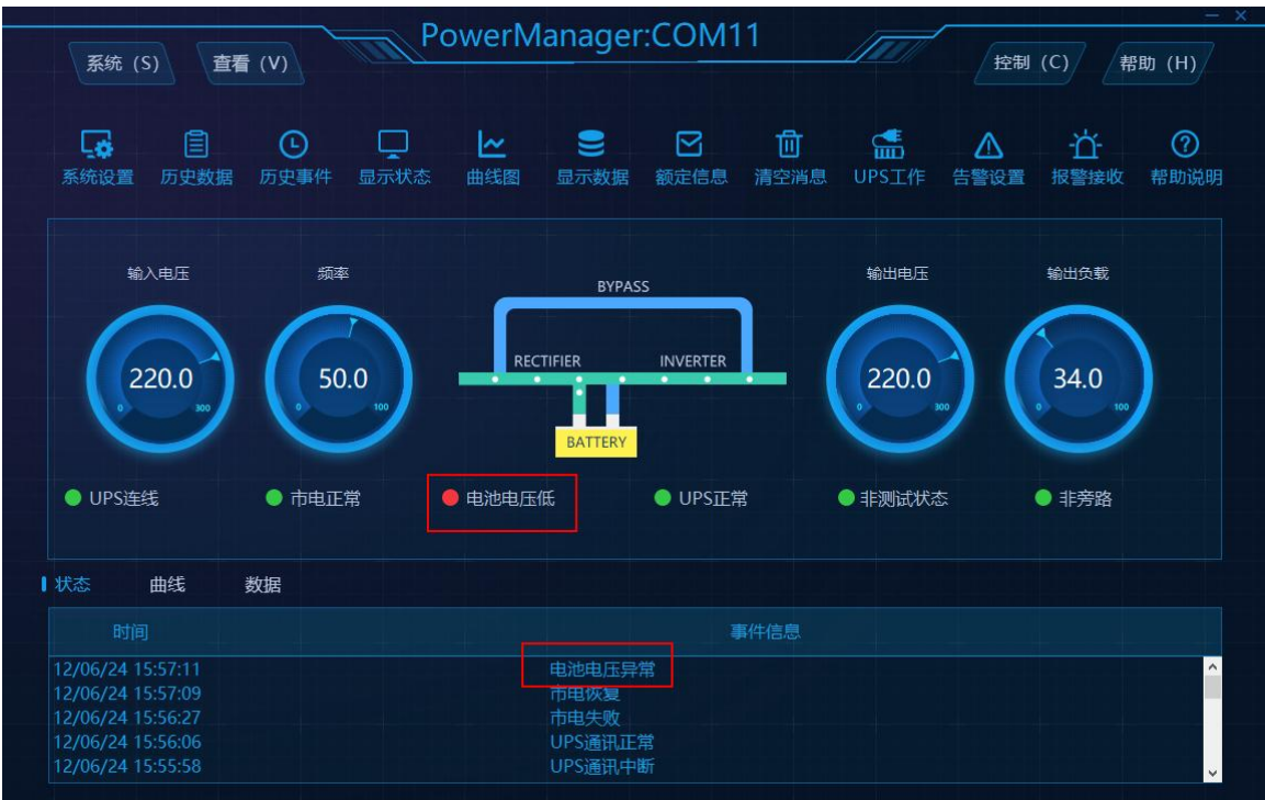
3: 电池电压低告警如下图：电池电压低指示灯显红色，告警栏出现电池电压异常的信息；
